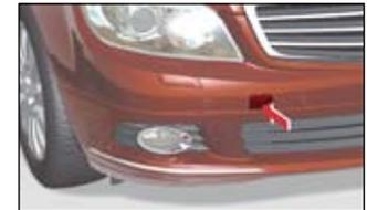
Aufnahmen für Abschleppstange/-seil am Beispiel C-Klasse (Abschleppösen befinden sich beim Bordwerkzeug). Die konkreten Ansatzpunkte für das betroffene Fahrzeug werden in der zugehörigen Betriebsanleitung beschrieben.
